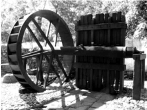
Fotografia 07 - Primeiros equipamentos (pilões) utilizados no período das companhias mineradoras (Fotografia de Antonio Liccardo)
