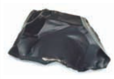
A obsidiana é um vidro vulcânico que também apresenta fratura do tipo conchoidal
