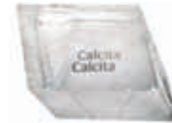
Calcita - transparente. Permite a visualização de detalhes e mostra ainda a imagem duplicada (birrefringência)
