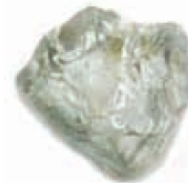
Quartzo mostrando fratura conchoidal
