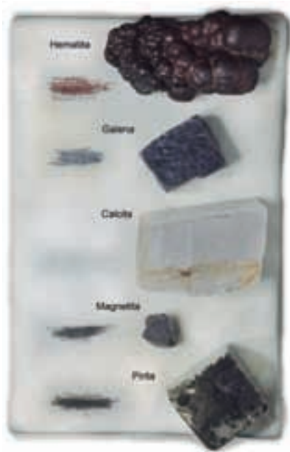
Hematita - traço avermelhado
