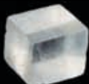
Clivagem muito boa em três direções na calcita
